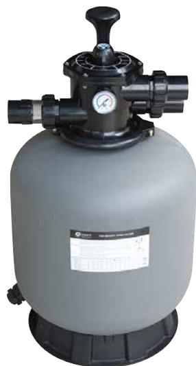
El depósito de este filtro fabricado en polietileno ha sido bienvenido en la industria por su fiabilidad, rendimiento y reducido coste. Gracias al uso de materiales resistentes a los rayos UV, este filtro es apto para las instalaciones en el exterior. Los modelos serie "P" (P350-P700) están equipados con una válvula selectora superior de 6 vías y brazos colectores en ABS.
