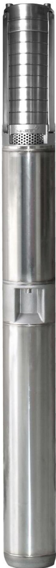
Las bombas 4HS MP son fabricadas 100% en acero inoxidable AISI 304, garantizando así una larga vida útil de todos sus componentes. La sección hidráulica, el motor y sus componentes puede desmontarse y reemplazarse fácilmente.
